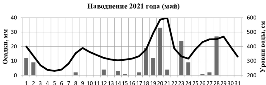
Рис. 5. Соотношение хода осадков на м/с Яйлю и уровней воды на г/п Абаза в мае 2021 г.
