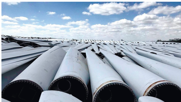
Рис. 3. Кладбище примерно 1000 стекловолоконных лопастей с трех ВЭС, построенных на северо-западе США в 1990-х гг. в первую волну ветроэнергетики и отработавших 25 лет. Каждую лопасть разрежут на три части и затем все захоронят [39].
